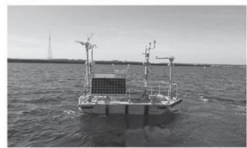
シシング技術を導入し、風況調査や強度データを取り込んだ予測シミュレーションを開発。複雑で厳しい日本の自然環境の下で開発を進める国内の事業者は、より高精度な風況データを提供する。洋上風力発電用のウェーブビデオメトロ学（WAVE VIDEO METROLOGY）によって、洋上風況予測支援を行った。洋上観測タワーを設置するのと比べ、大幅な経費削減を実現する。
